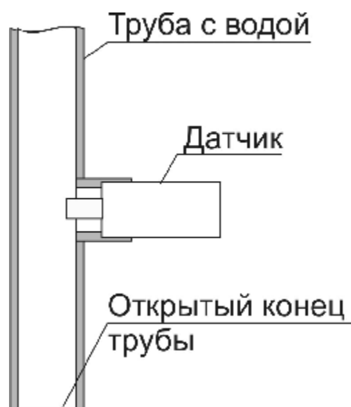
Рис. 4. Установка датчика на трубе.
